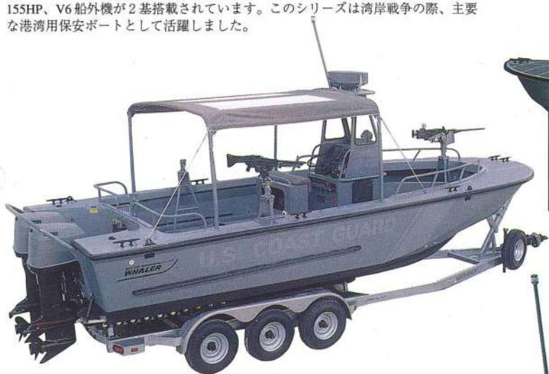
27' GUARDIAN, ( ガーディアン ) "ビラニアシリーズ" アメリカ沿岸警備隊の中で、防衛隊を補助するものとし設計、製造されアラブ湾岸にも配備されました。多様な 50 口径ガン装備、スピードは船外機の選択により 50 + α ノット迄変化をつけられます。
