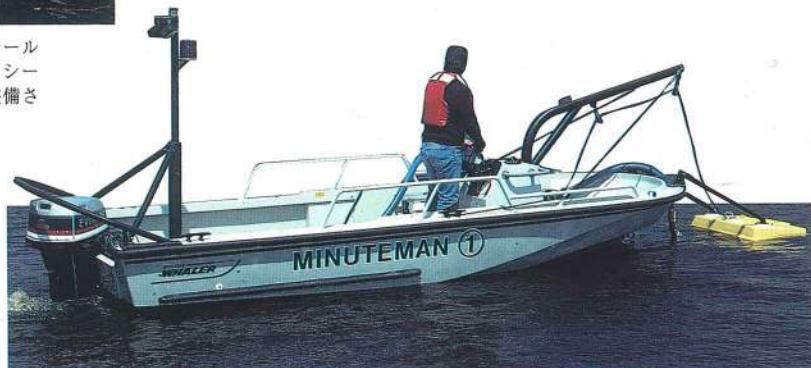
19' GUARDIAN, (ガーディアン) “ミニットマン” 汚染対策パッケージ、船上ポンプシステムと22,710リットル／時処理能力をもつすくい取り機装備を特徴としています。オイルは固定タンク又はプラッタータンクに収納されます。他の用途としては牽引、ユーティリティー機能の活用及びV.I.P.の輸送があげられます。各種サイズを取り揃えています。
