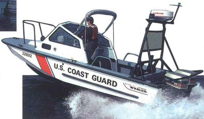
22' SENTRY, ( セントリイ ) アメリカ沿岸警備隊向けとして、探索、レスキュー作業に迅速な対応が出来ます。100馬力の船外機を 2 基搭載するこの SENTRY は、高速旋回性能に優れ、走行性も抜群です。荒海でも静止状態でも安定性があり、そして視界良好なことも警備隊用に採用されている理由です。
