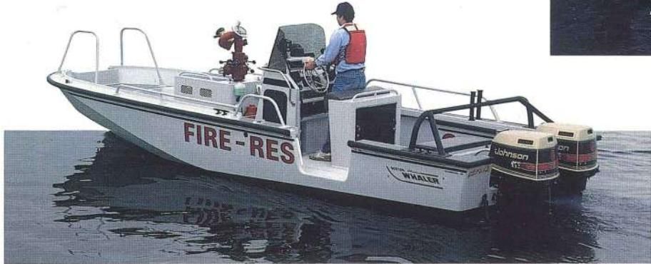
25' GUARDIAN( ガーディアン ) 75HP のプロンズ製ポンプ搭載。アタックモード又、浅瀬での使用で 2271 リットル / min @ 100P.S.I. 可能。86cm のダイブドアとトーシャナル牽引バーを加えればフルパッケージになります。
