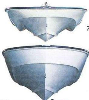
世界的に有名なデザイン ポストンホエラーの小型艇は、走行中も水しぶきがかからず、安定感のある乗り心地をもたらす独自の TRI-HULL を採用しています。大型艇は、この TRI-HULL に手を加えたバージョンです。荒海をスムーズに、安全に、そして 快適に乗り切るたぐいまれな安定感と凌波性を生む設計となっています。
