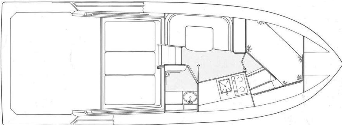
キャビン標準装備品：ギャレイ、冷温水付シンク、AC/DC冷蔵庫、コンバーティブルテーブル、電気式料理用ストーブ。ステートルーム；プライバシードア、ビロー付ベット、ハンギングロッカー。トイレルーム；シンク、ビルジポンプ付シャワー、ホールディングタンク付電動マリントイレ、清水コネクション、温水ヒーター、キャビネット
