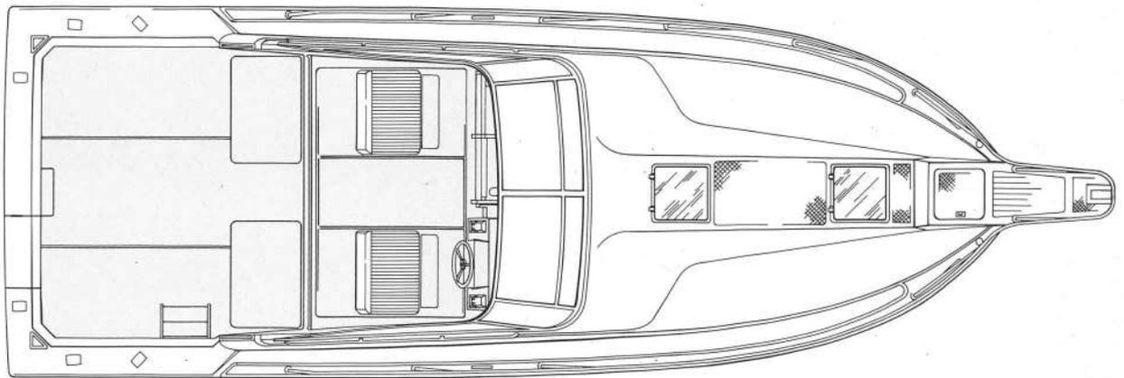
船体、デッキ、コックピット標準装備品：トリムタブ、レール及びアンカーローラー付パウバルピット、開閉付アンカーロッカー(前部)、チーク製ロッドラック(コックピット)ポーディングラダー、ロッドホルダー(4)、甲板洗浄配管、コックピットユースパッド
