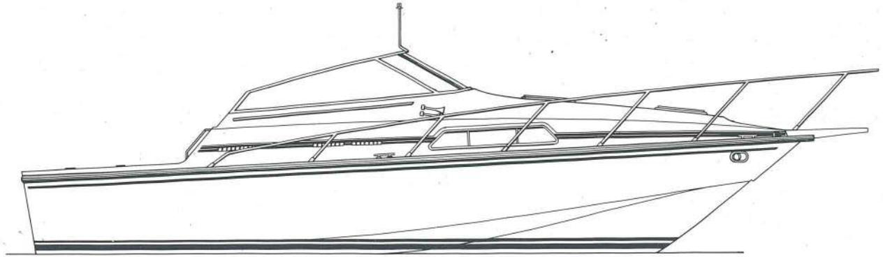
主要目：全長9.65M、全幅3.60M、吃水0.96M、排水量(軽荷)5.8TON、燃料容量1,230ℓ、清水容量150ℓ
